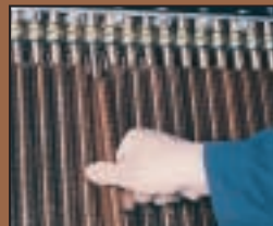
El tubo nuevo se inserta en un sello nuevo. Si no se cuenta con tubos de reemplazo, los orificios pueden sellarse temporalmente usando tapones especiales MESABI® para posteriormente reemplazarlos por un tubo nuevo.
